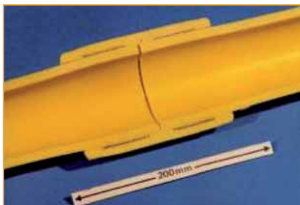
Figura 2. Sección transversal de una junta por EF de una tubería de gas, mostrando la posición de la bobina calefactora Figure 2 Section through an electrofusion joint in a PE gas pipe, showing the position of the heating wire coils.
